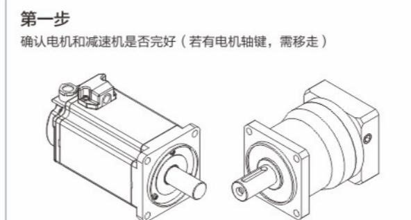
安装前确认电机和减速机是否完好无损, 并且严格检查电机与减速机相连接的各部位尺寸是否匹配, 主要指电机的凸台尺寸与减速机凹槽等尺寸及配合公差。
