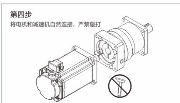
连接时必须保证减速机输出轴与电机输入轴同轴度一致, 且二者外侧法兰平行, 如果轴度不一致, 会导致电机轴折断或减速机齿轮磨损。另外, 在安装时, 严禁用铁锤等击打, 防止轴向力或径向力过大损坏轴承或齿轮。
