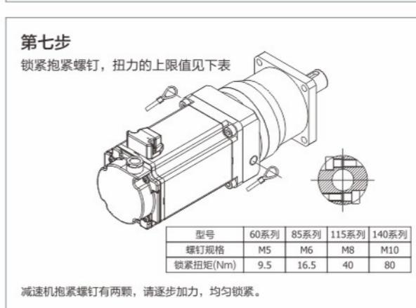
减速机抱紧螺钉有两颗, 请逐步加力, 均匀锁紧。
