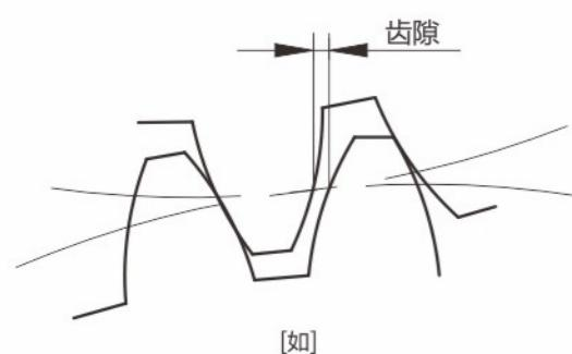
**定位精确度:** 在高速机械往复运动中做到精确定位的关键在于尽量减小通过运动产生的角偏差, 定位精确度取决于两个值, 一个是与加载有关的偏转角, 涉及到回程间隙与扭转刚度, 另一个与运动控制有关偏转角, 涉及到同步偏差问题。
