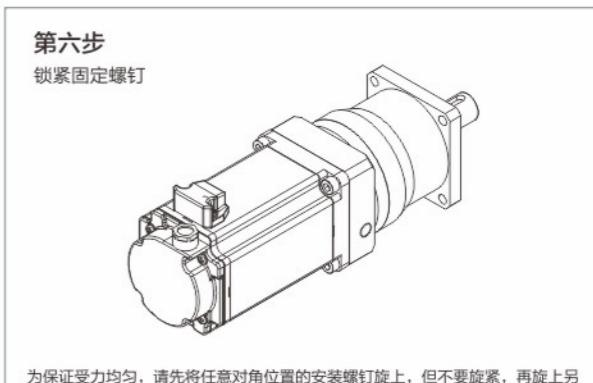
为保证受力均匀, 请先将任意对角位置的安装螺钉旋上, 但不要旋紧, 再旋上另外两个对角位置的安装螺钉, 最后逐个旋紧四个安装螺钉。
