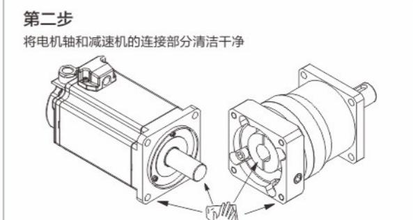
将电机输出轴、定位凸台及减速机连接部位的防锈油用汽油或锌钠水擦拭干净, 其目的是保证连接的紧密性及运转的灵活性, 并且防止不必要的磨损。
