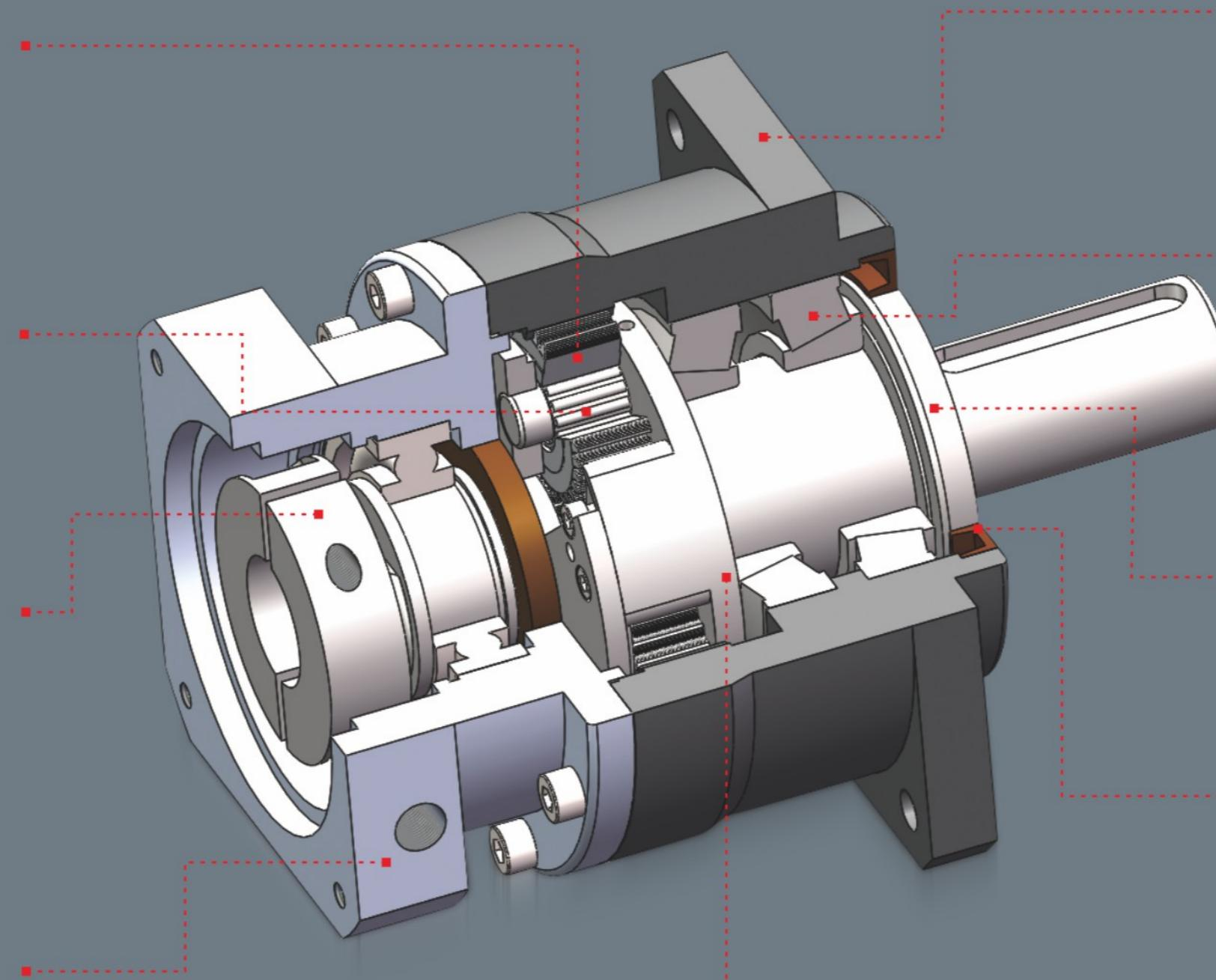
输出法兰、内齿圈二者为一体，可确保零件的同心度要求，为实现低噪声提供保障。
