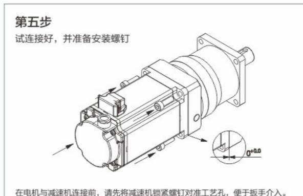
在电机与减速机连接前, 请先将减速机锁紧螺钉对准工艺孔, 便于扳手介入。
