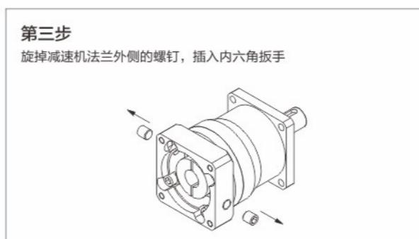
取下减速机法兰外侧工艺孔上的防尘盖, 调整减速机输入轴弹性夹紧装置使其坚固螺栓与工艺孔对齐, 插入内六角扳手。此步骤适合筒夹式锁紧机构联接。
